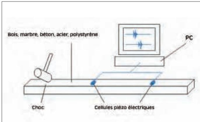
Mesures de vitesse d'ondes, réalisée à l'aide de cellules piézo électriques disposées sur divers matériaux. Les deux cellules piézo électriques sont raccordées à la "carte son" de l'ordinateur.
