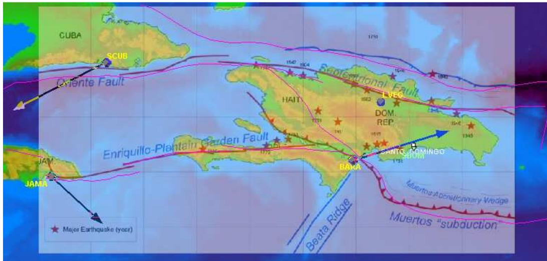
Ce qui est important est d'évaluer la vitesse avec laquelle les blocs glissent les uns par rapport aux autres le long de ces failles. Le fichier GPS\_GLOBAL\_DATA nous permet une telle évaluation. On constate que de part et d'autre des failles, la lithosphère n'est pas soumise au même vitesse de déplacement. Ainsi, de part et d'autre de la faille d'Enriquillo, un mouvement relatif de 7mm/an est constaté ; il est de 9 mm/an pour la faille septentrionale.
