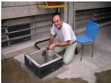
Installation du sismomètre
