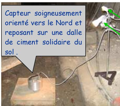
Capteur soigneusement orienté vers le Nord et reposant sur une dalle de ciment solidaire du sol.
